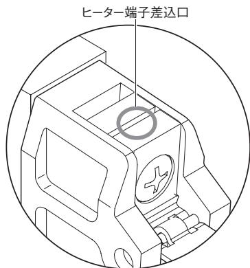
**⚠ 警告** ヒーター端子を電極に差込む位置を間違えると、シール時、電極部分でショートするので、充分気をつけて取り付けを行なってください。
