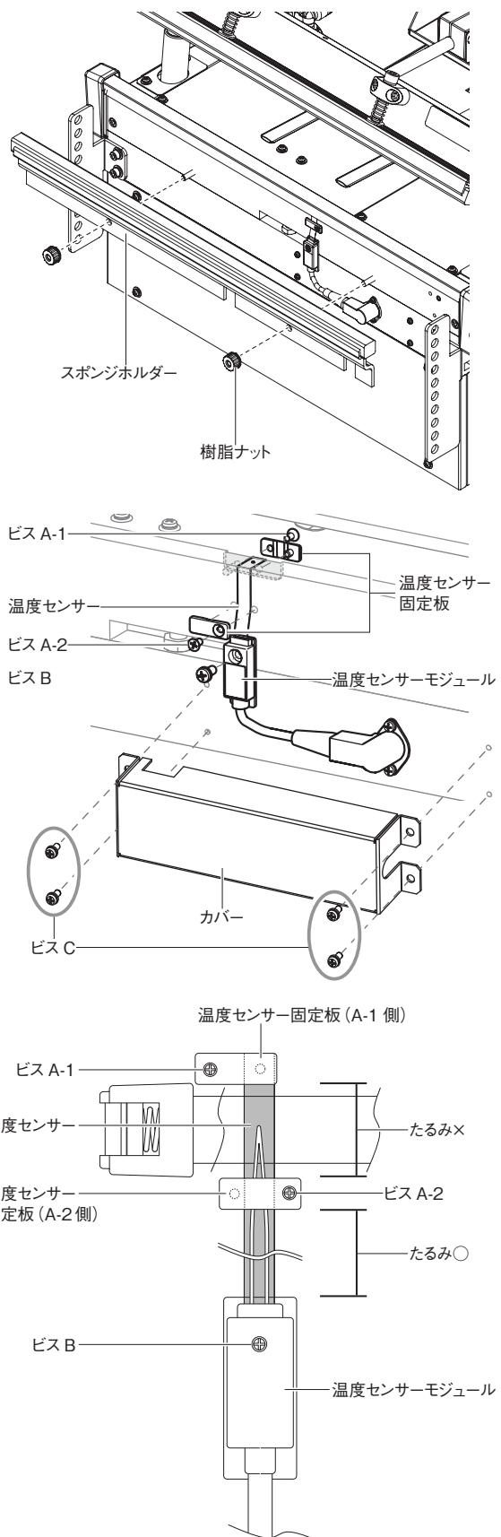
9 温度センサー モジュールを固定してください。
