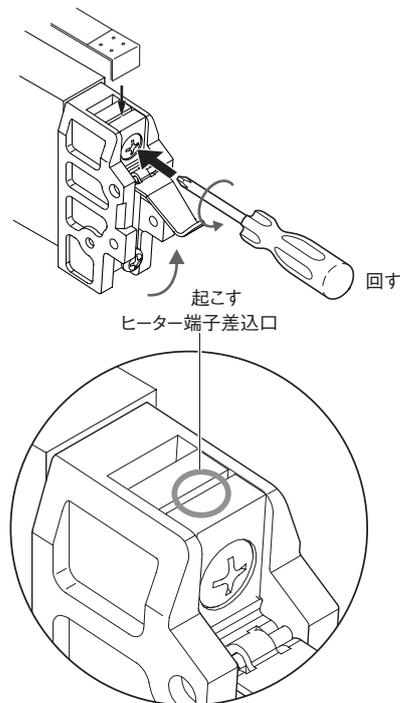
**警告** ヒーター端子を電極に差込む位置を間違えると、シール時、電極部分でショートするので、充分気をつけて取り付けを行ってください。
