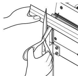
**注！** 貼り替え時の注意：センタードライテープの中心にヒーターが位置するようにして、センタードライテープの両サイドをシール受け板に貼り付けてください。センタードライテープにシワがある状態で貼り付けると、シールにもシワ模様が出ます。
