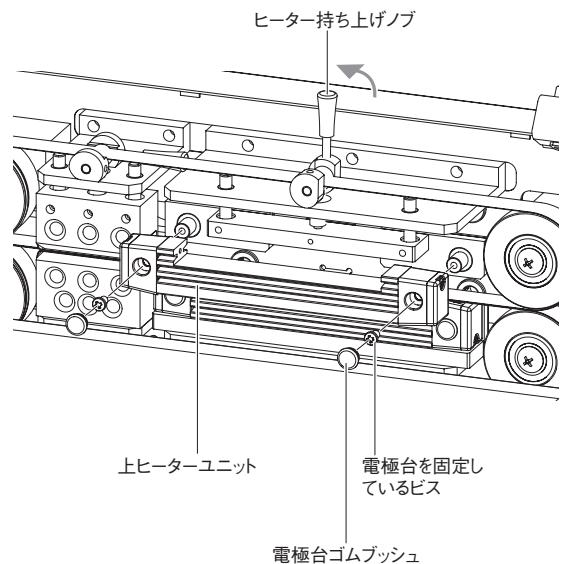
**注！** 上ヒーターユニットは前後があります。前後逆に取り付けると正しくシールが出来なくなりますので、下イラストを参照して、正しく取り付けてください。
