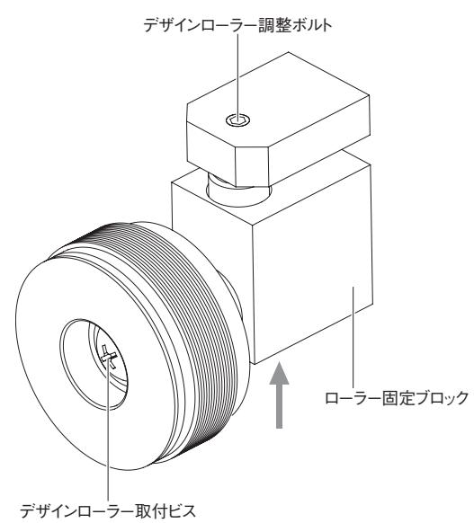
**注！** デザインローラーを交換した場合、デザインローラーの圧力調整をする必要がありますので「1-11-4 デザインローラーの調整」(→ P.31) を参照して、調整を行ってください。
