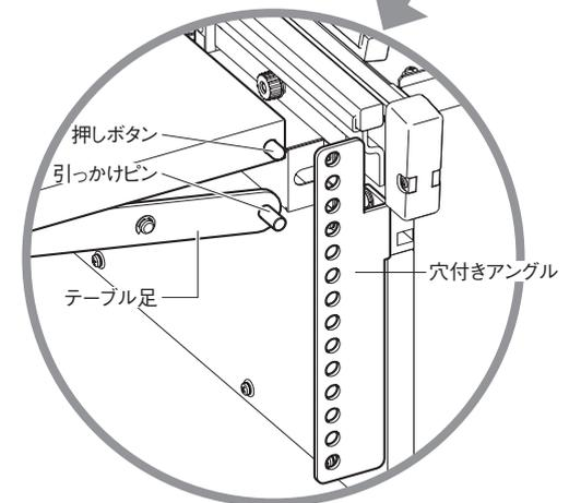
**警告** 押しボタン、引っかけピンは必ず確実に穴付きアングルの穴へ差し込んでください。確実にセットされていないと、少しの衝撃やテーブルの持ち上げによってテーブルが外れたり傾いたり、落下してケガをする恐れがあります。
