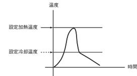
加熱時間を設定した場合の加熱温度測定グラフの軌跡
