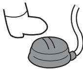
圧着レバーが下降し、袋をスポンジで挟み込み密封します。圧着レバーが閉じるまで踏んだ状態を保ってください。
