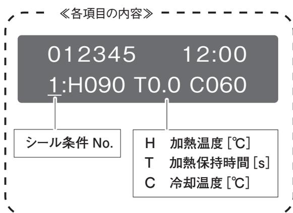
(ここでは例として H 加熱時間にカーソルを移動させたものとします)
