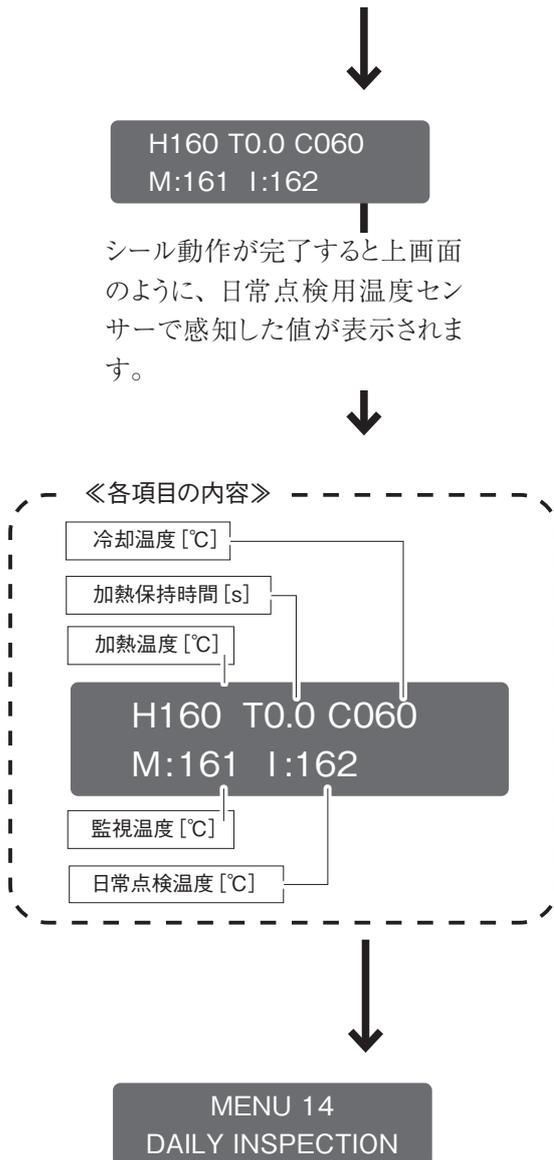
データの確認が完了したら何れかのキーを押して前の画面に戻るか、**MENU** キーを押して日常点検を終了してください。
