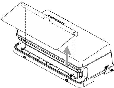
②受け板の中央部から出ているキャップボルトに日常点検ユニットのだるま穴を引っ掛け、温度センサーがシール面に乗るようにセットしてください。
