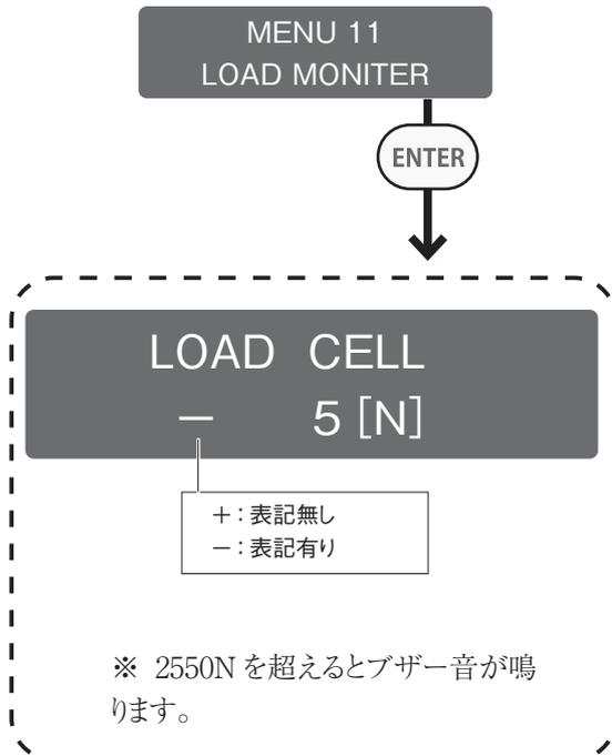
選択すると上の画面が表示され、現在圧力センサーに掛かっている荷重が表示されます。(ここでは例として-5Nとしています)
