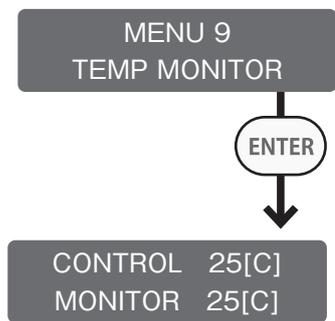
選択すると画面に現在温度センサーが感知している温度が表示されます。
