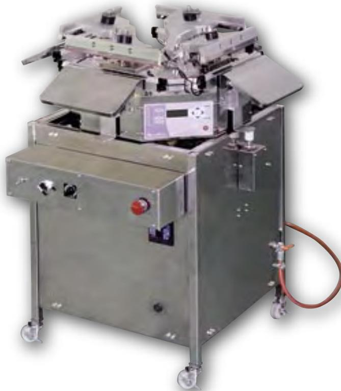
富士インパルス：インデックスシーラーは、間欠回転するインデックステーブルに4台の電動シールユニットを搭載し、定位置でシールユニットに袋を供給、連続的にシーリングを行うことが可能です。
