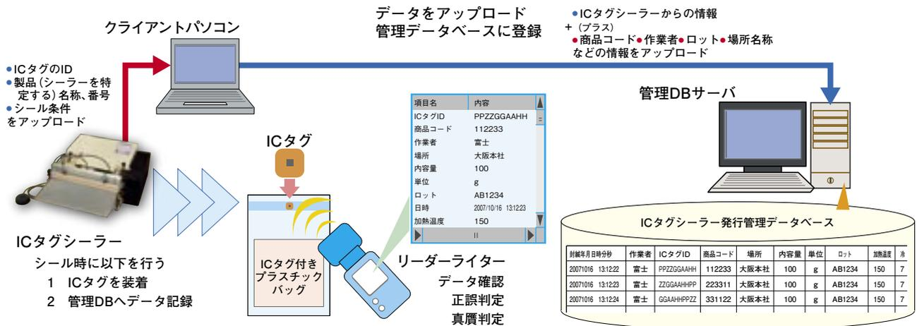
富士インパルス:IC タグシーラーは、シール時に1. IC タグの取付、2. 管理 DB へデータ記録を自動で行い、IC タグ取り付け作業負担を軽減し、IC タグと実データをリンクします。IC タグと袋が一体となるので、偽造が困難となります。
