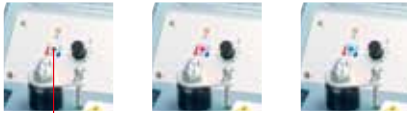
加熱冷却ランプ 加熱時間 冷却時間 赤色に点灯 青色に点灯 ■ 画像のランプの発光はイメージです
