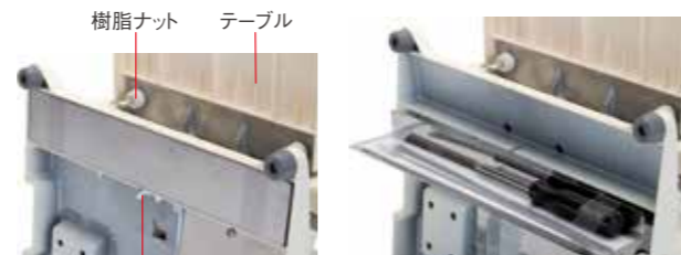
樹脂ナット テーブル パーツカバーを固定している蝶ナットを緩めます 機械底面から見た状態です
