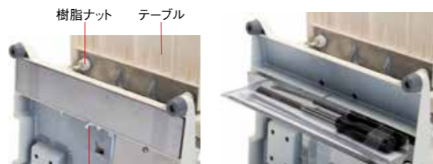
樹脂ナット テーブル パーツカバーを固定している蝶ナットを緩めます 機械底面から見た状態です
